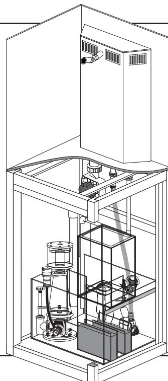
Plaats de bijvulbak (17) op de sump. Sluit de vlotterslang (11) aan op de vlotter.
