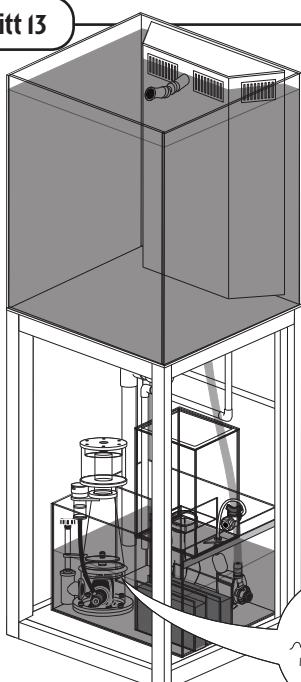
Den Hahn des Durchgangsrohres öffnen und das Aquarium füllen, bis der maximale Wasserstand im Sumpf erreicht ist.
