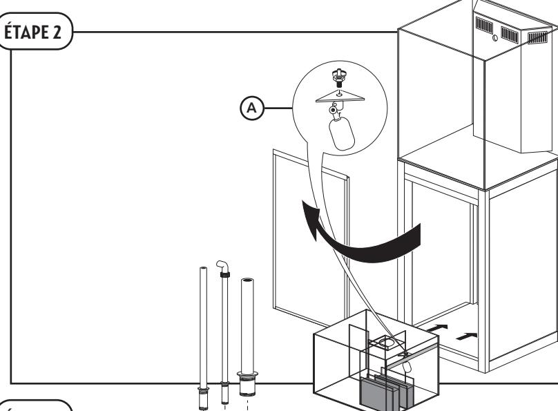
Montez (A) le flotteur (13) dans le bac à décantation (16).
