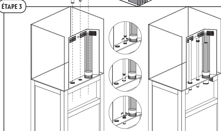
Placez le tube de circulation (1), le tube de refoulement (4) et le tube de débordement (6) dans leur emplacement.
