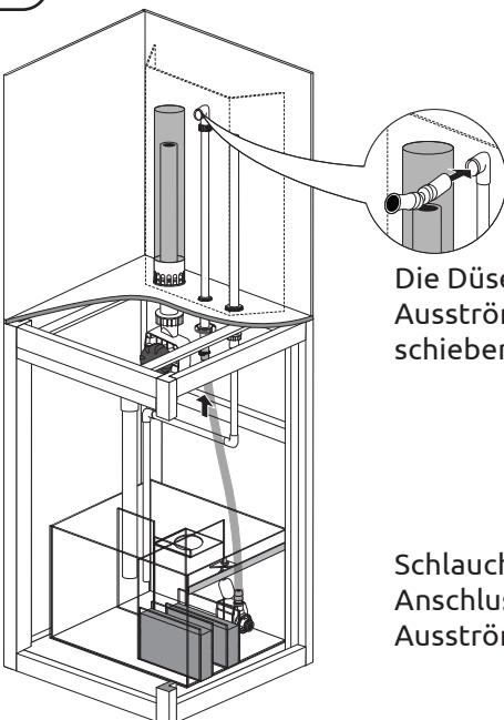
Schlauch (8) auf den Anschluss des Ausströmrohrs (4)
