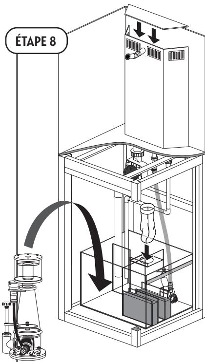
Placez la chaussette de préfiltration (18) et l'écumeur (7) dans leur compartiment du bac à décantation.
