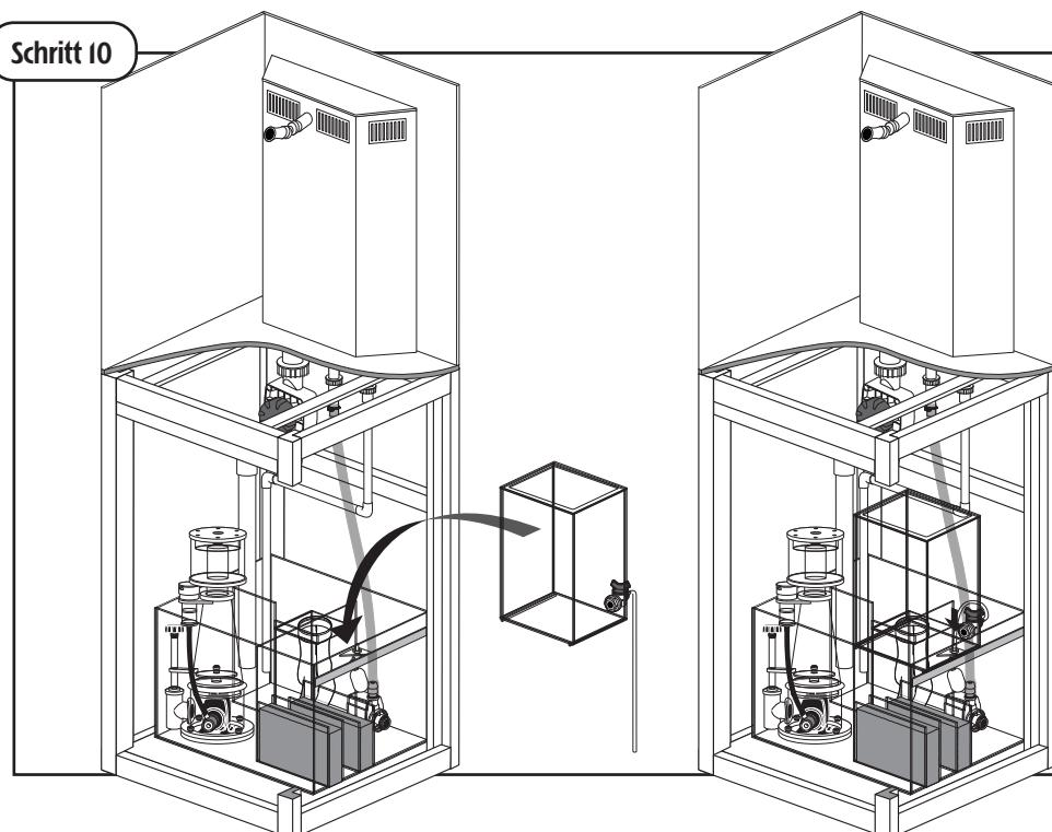
Setzen Sie den Nachfülltank (17) auf den Sumpf. Verbinden Sie den Schwimmerschlauch (11) mit dem Schwimmer.
