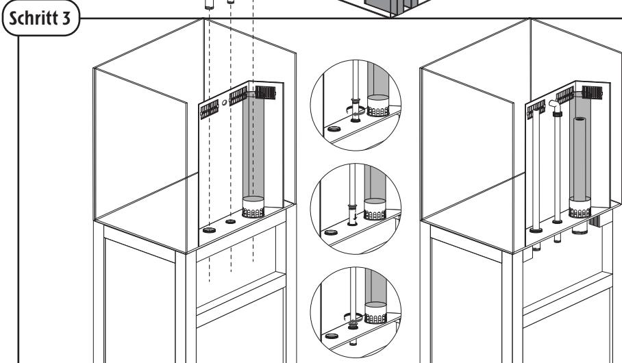
Platzieren Sie das Durchgangsrohr (1), das Ausströmrohr (4) und das Überlaufrohr (6) in die Bohrungen.
