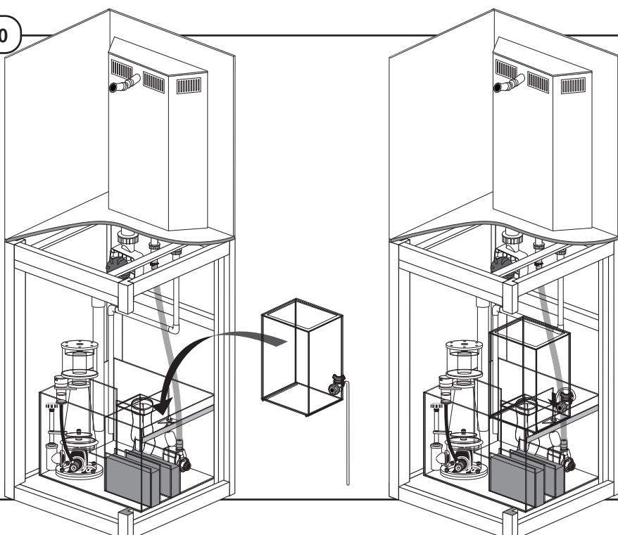
Placez le réservoir d'eau (17) sur le bac à décantation. Connectez le tuyau du réservoir (11) sur le flotteur.
