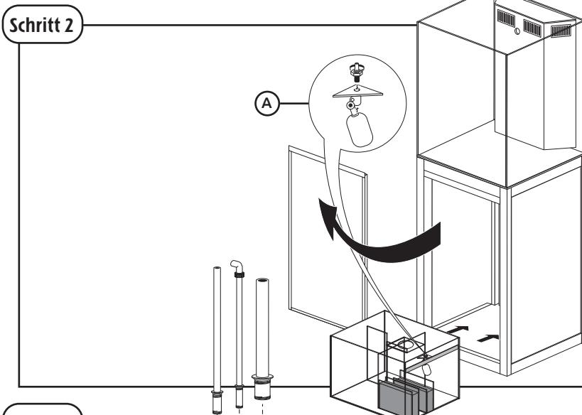
Montieren Sie (A) den Schwimmer (13) im Sumpf (16).
