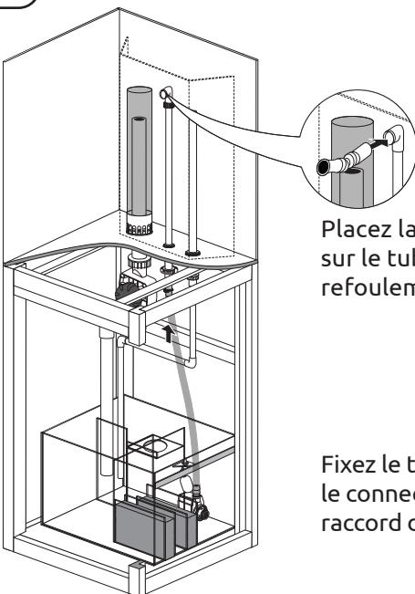
Fixez le tuyau (8) sur le connecteur du raccord du tuyau (4)
