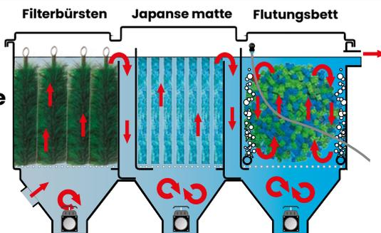
Maximales Teichvolumen 20 m<sup>3</sup>, empfohlene Pumpenleistung 5000L/h, Lieferung komplett mit Filterbürste, Aqwise-Schwimmschichtmedien, Filterabdeckung, geeignet für Pumpenaufstellung,
