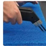
Einfach zu schneiden mit einem heißen Messer oder einer Schere.
